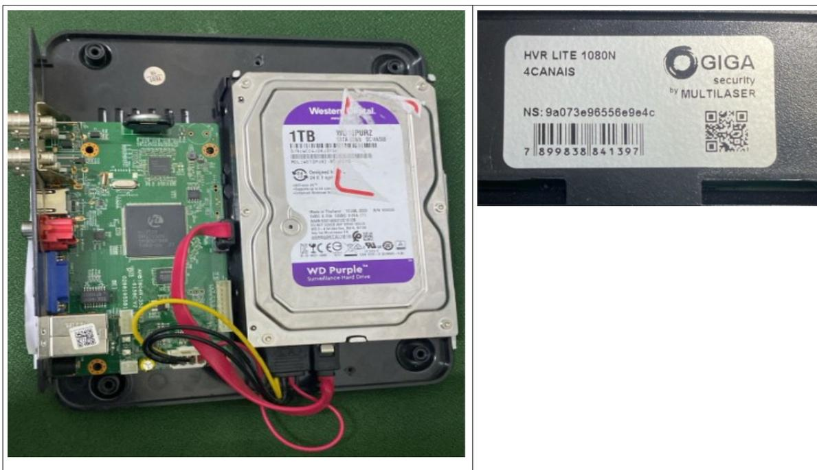
O equipamento **DVR (Digital Video Recorder)**, usado para gravar, armazenar e reproduzir imagens em sistema de monitoramento do tipo CFTV (Circuito Fechado de Televisão), faz gravações contínuas das imagens captadas por câmeras de segurança.
